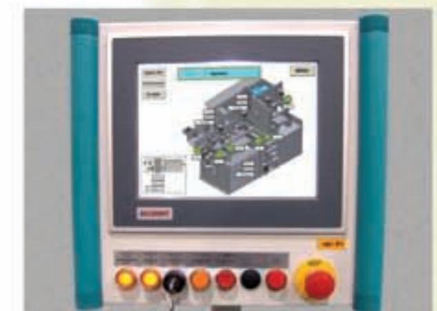
Hochleistungs- SPS mit Vollgrafischem 12" Multi Color Display - Touchscreen.
