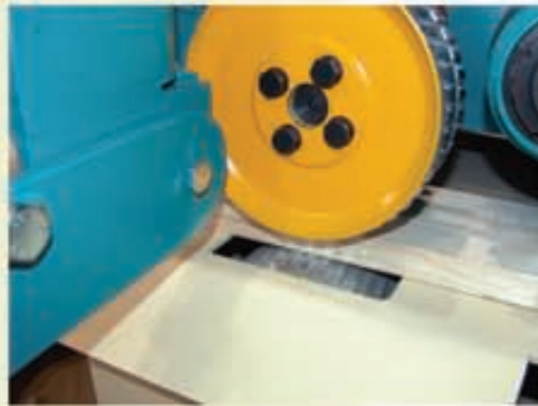
Integriertes Einzugsrollenpaar für kontinuierliche Beschickung (auch Lagenweise und unvereinzelte möglich!).
