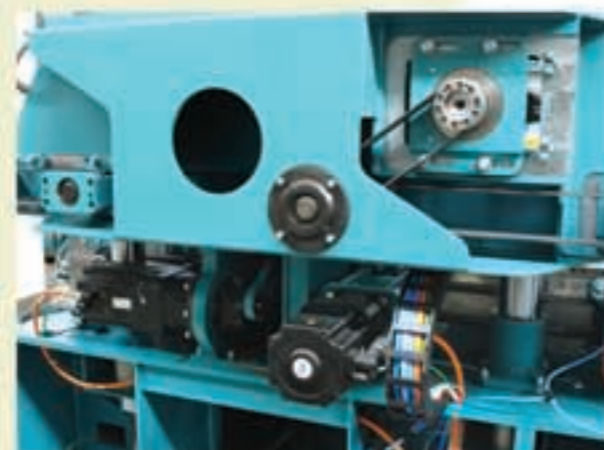
Materialvorschub sowie Sägenhub sind mit modernster Servotechnik der neuesten Generation ausgestattet.
