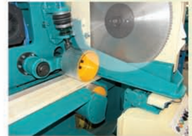
Sägenhub durch Servoantrieb vorpositionierbar von oben wirkend!
