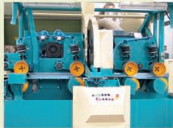
Über Hochleistungs-Planetengetriebe werden alle oberen und unteren Vorschubwalzen angetrieben. Allradantrieb garantiert 100% Schlupffreien Transport der Werkstücke.
