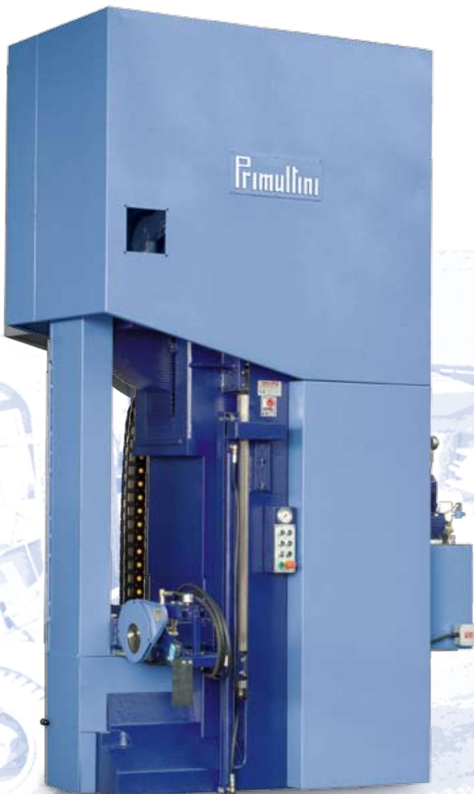
● Struttura portante completamente in ghisa con volani a disco pieno di fusione bilanciati dinamicamente.
